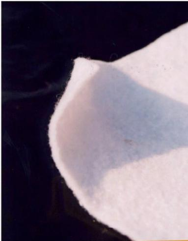
Géotextile aiguilleté Geo PP
