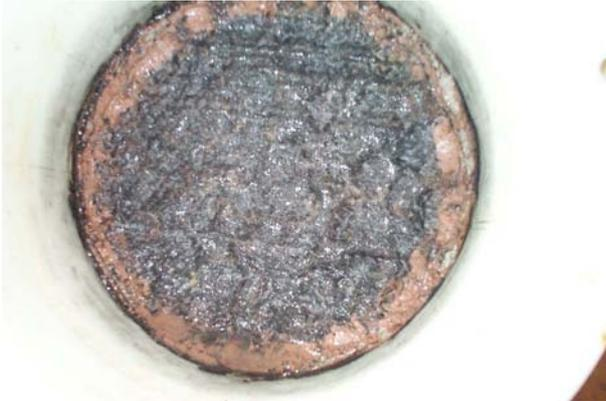
Figure 13. Face supérieure du GSB à l'autopsie
