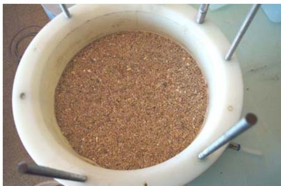
Figure 9. Gravier 2/5 sur géocomposite de drainage
