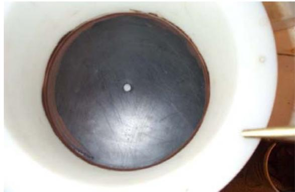
Figure 6. Géomembrane percée au centre
