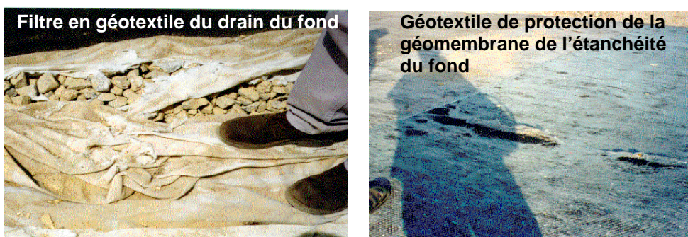
Figure 18. Endommagements à la fin de 2 mois d'exposition aux UV (Lopes, 2003b).
