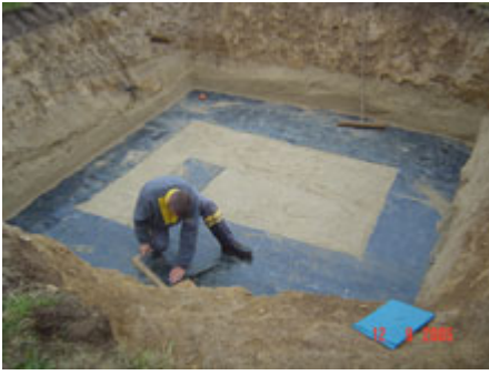
Photo n° 4 - Découpage d'un échantillon de membrane
