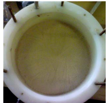
Figure 11. couche de sable pour régaling final
