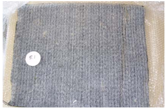
Figure 8. GSB recouvert in situ par un géosynthétique de drainage
