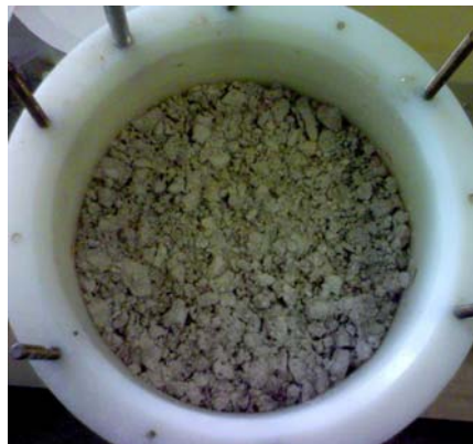
Figure 10. couche de craie compactée sur GSB
