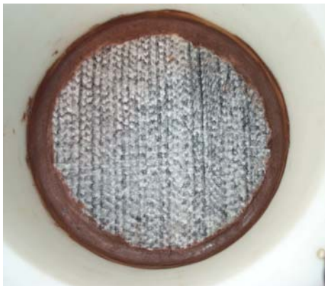
Figure 9. GSB placé dans embase (étanchéité latérale)
