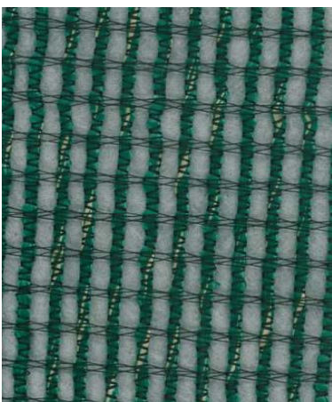
Figure 8. Géotextile de renforcement.
