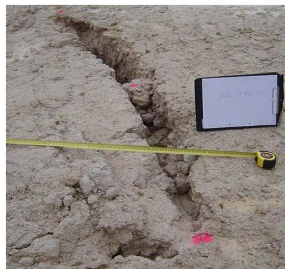
Figure 3. Photographies des diaclases observées en fond de forme
