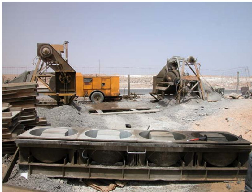
Figure 6. Vue du site de fabrication des éléments cellulaire du parement
