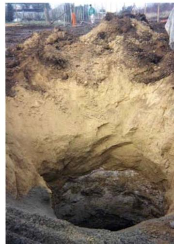
Figure 3. Ouverture d'un fontis en surface
