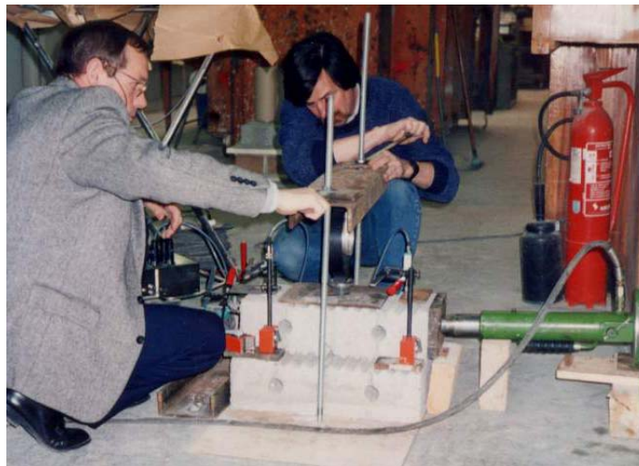
Figure 2. Essais à la rupture et au cisaillement
