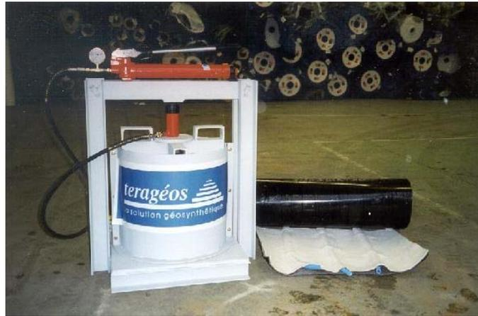
Figure 1. Cellule de poinçonnement expérimental à 400kPa
