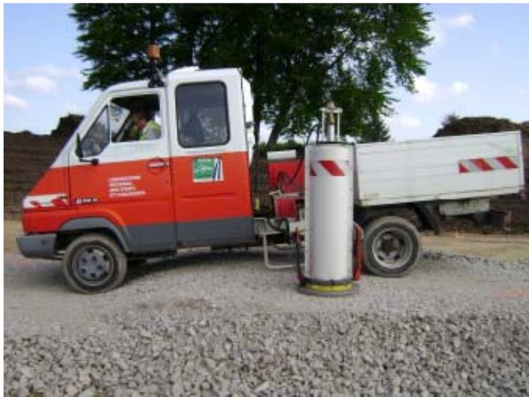
Figure 2. Essais à la Dynaplaque 2 effectués par le LRPC de Clermont-Ferrand
