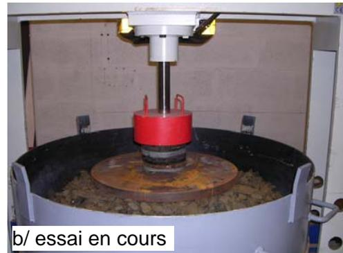
Figure 2. Simulation en laboratoire de l'endommagement statique
