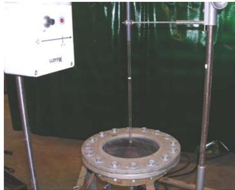
Figure 7. Appareillage utilisé pour les essais de traction bi-axiale
