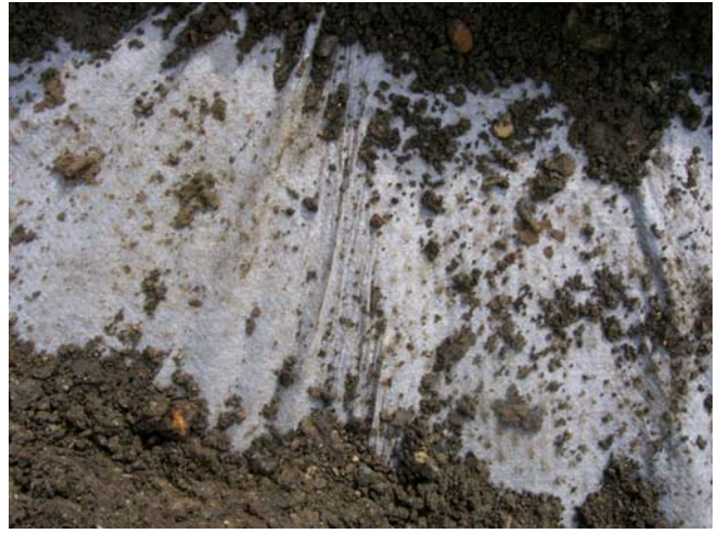
Figure 9. Décollage du géotextile
