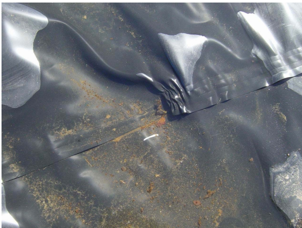
Figure 4. Défaut de soudure en surface courante
