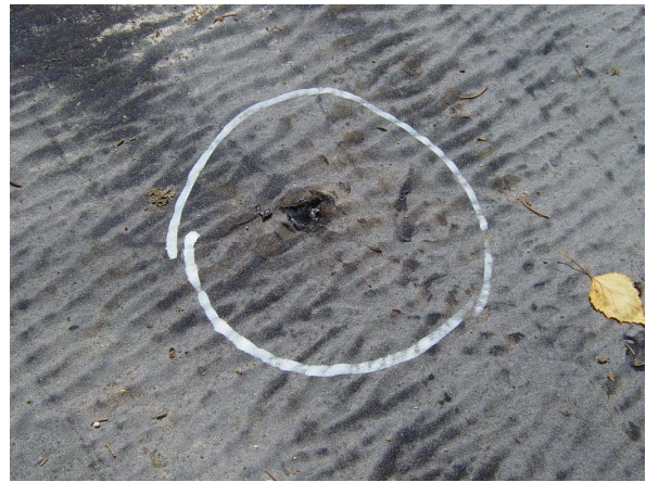
Figure 3. Poinçonnement d'une géomembrane bitumineuse
