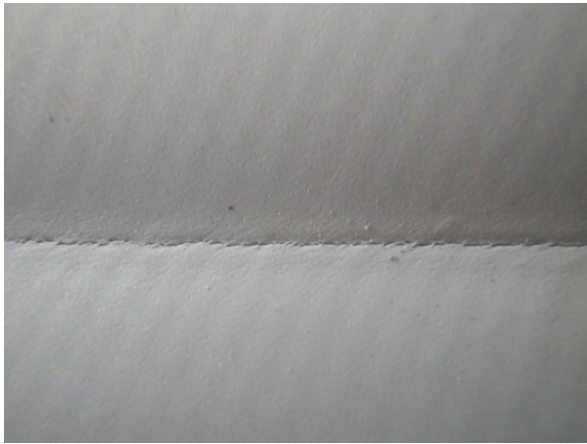
Figure 2. Altération de géomembrane PVC-P
