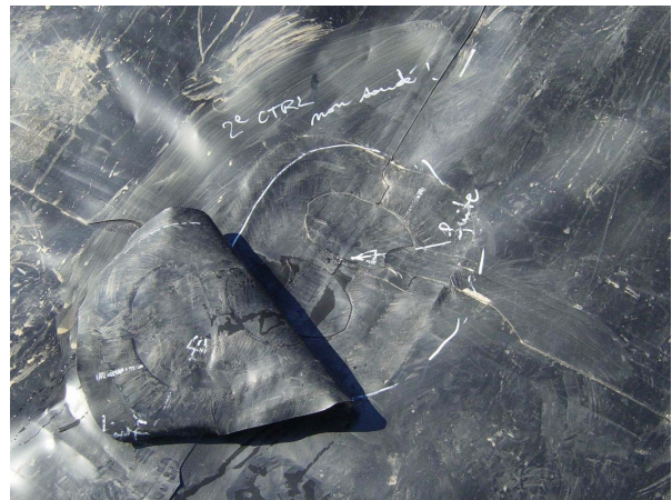
Figure 5. Défaut de soudure au niveau d'une pièce
