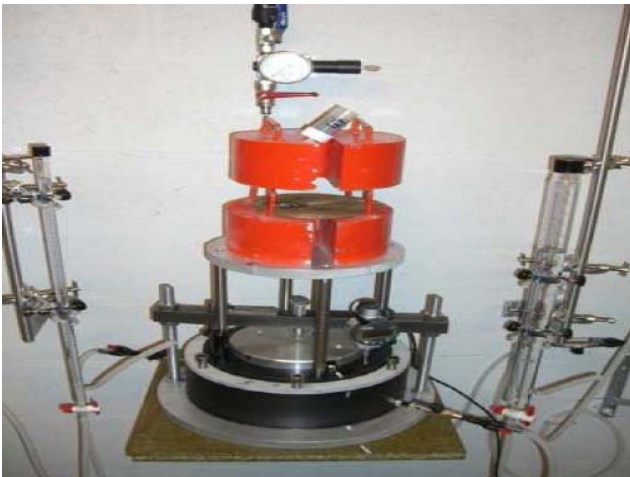
Figure 4. Gonflement avec contrainte (Photo CEMAGREF)
