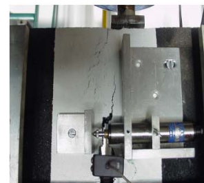
Échantillon renforcé après 570 000 cycles
