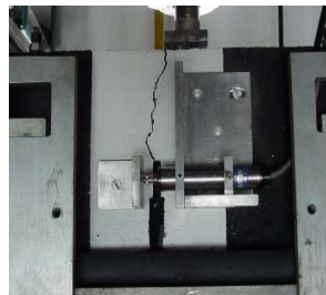
Échantillon non renforcé après 90 000 cycles
