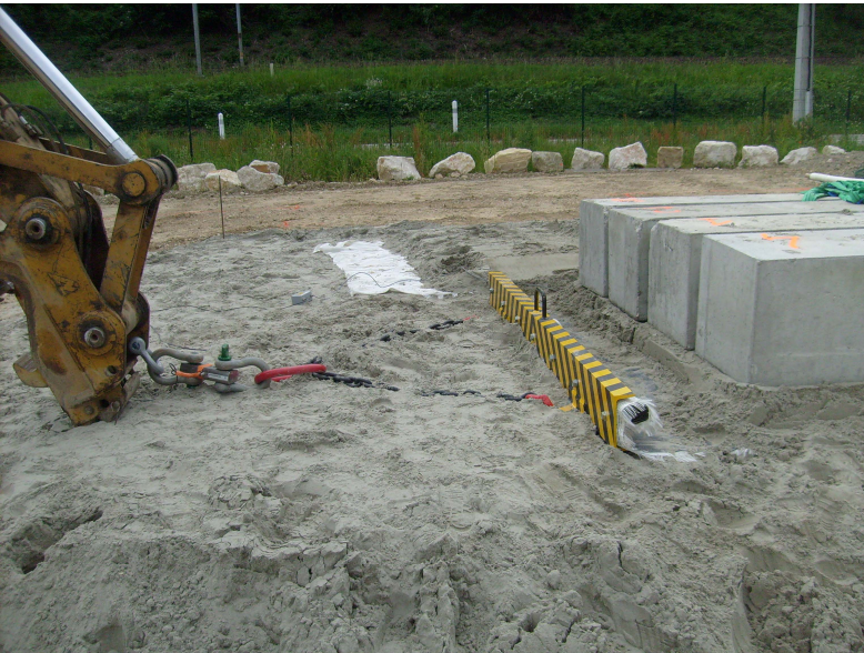
Figure 2. Essai de traction – frottement. Vue d'ensemble des blocs de chargement.
