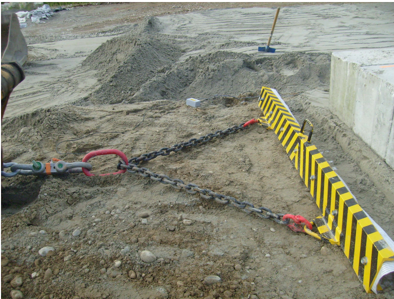
Figure 1. Essai de traction – frottement. Vue du portique de traction
