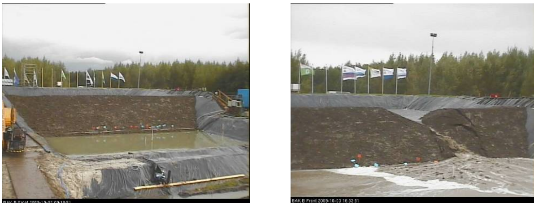
Figure 9. Projet IJKdijk/Piping – Une digue expérimentale avant et après rupture
