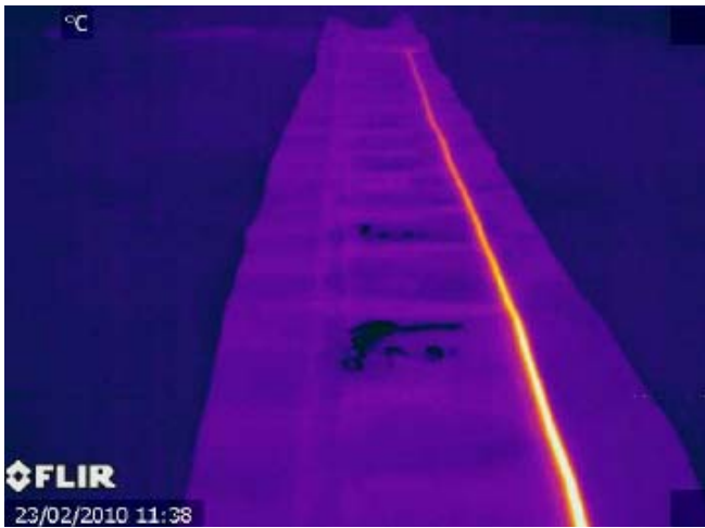
Figure 19. Vue infrarouge de la géomembrane avant réalisation d'un défaut de diamètre 1 mm
