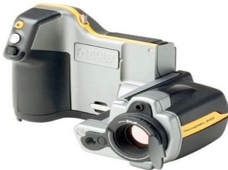
Figure 4. Vue de la caméra Thermacam Flir B 200 ® utilisée pour certains essais
