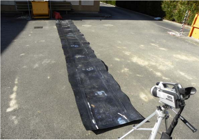
Figure 17. vue de l'acquisition des images thermographiques
