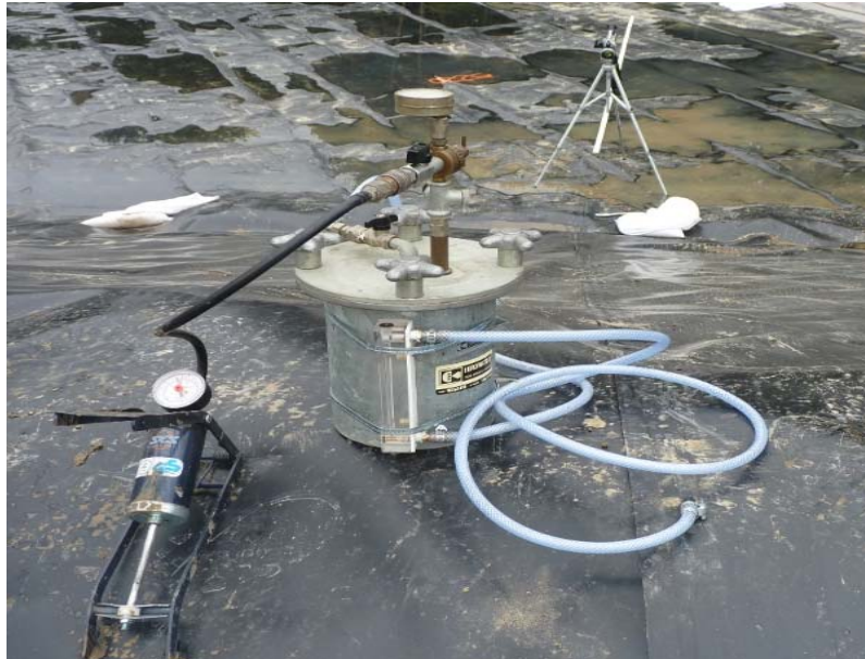
Figure 21. Vue du dispositif d'injection in situ
