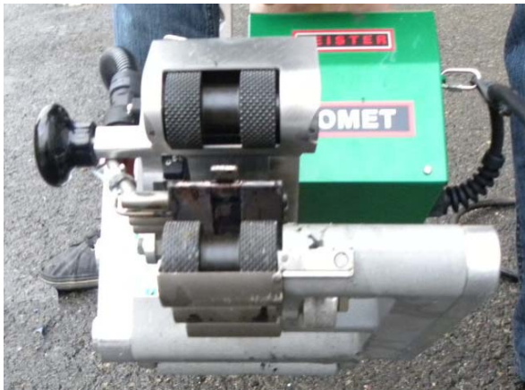
Figure 7. Vue de la machine « COMET » utilisée pour le soudage des corps d'épreuve en PEHD
