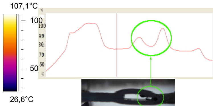
Figure 15. Vue du profil de température LI01 obtenu et de la découpe de la soudure à ce niveau.
