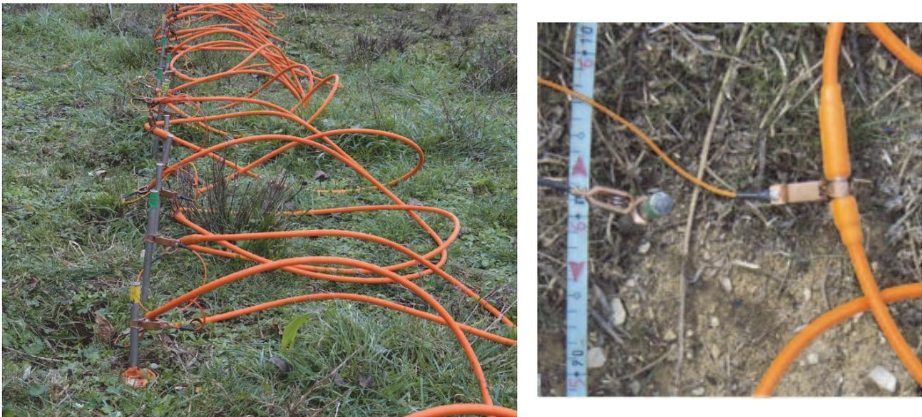
Figure 3. Photographie du matériel de mesures de tomographie de résistivité électrique
