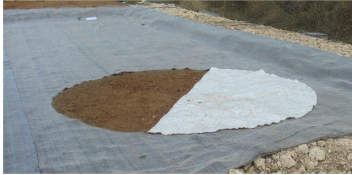
Figure 2. Photographie de l'arrachage créé au niveau du GSB
