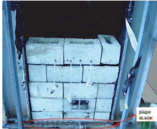
Figure 4. Tubes flexibles traversant les trous forés des blocs et ouvrage fixé à l'aide d'une plaque en acier
