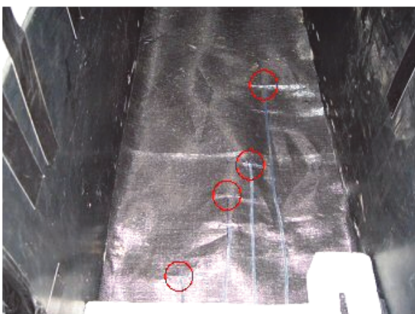
Figure 3a. Couche de géotextile et zones où les cordes monofilaments ont été attachées; 3b. Vue agrandie de la connexion de la corde monofilament autour de l'embout.
