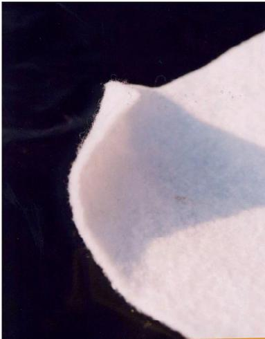
Géotextile aiguilleté Geo PP
