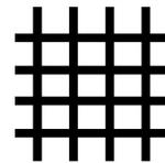
Les **géofilets** sont des matériaux analogues aux grilles, constitués de deux ensembles de brins grossiers parallèles de polymères extrudés, s'entrecroisant selon un angle aigu constant. Le maillage forme une nappe ayant une porosité dans le plan qui est utilisée pour véhiculer des débits relativement importants de fluides ou de gaz.
