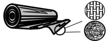
Les **géogrilles** sont des géosynthétiques ressemblant à des grilles ouvertes. La principale application des géogrilles est le renforcement des sols.
