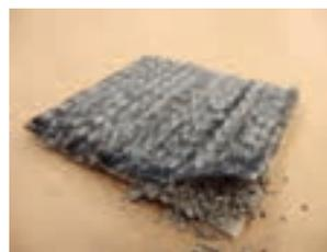
Figure 3. Exemple de géosynthétique bentonitique (© Irstea).
