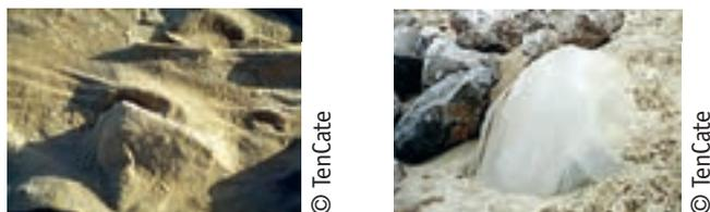
Figure 17. Exemples de déformation des géotextiles non tissés.
