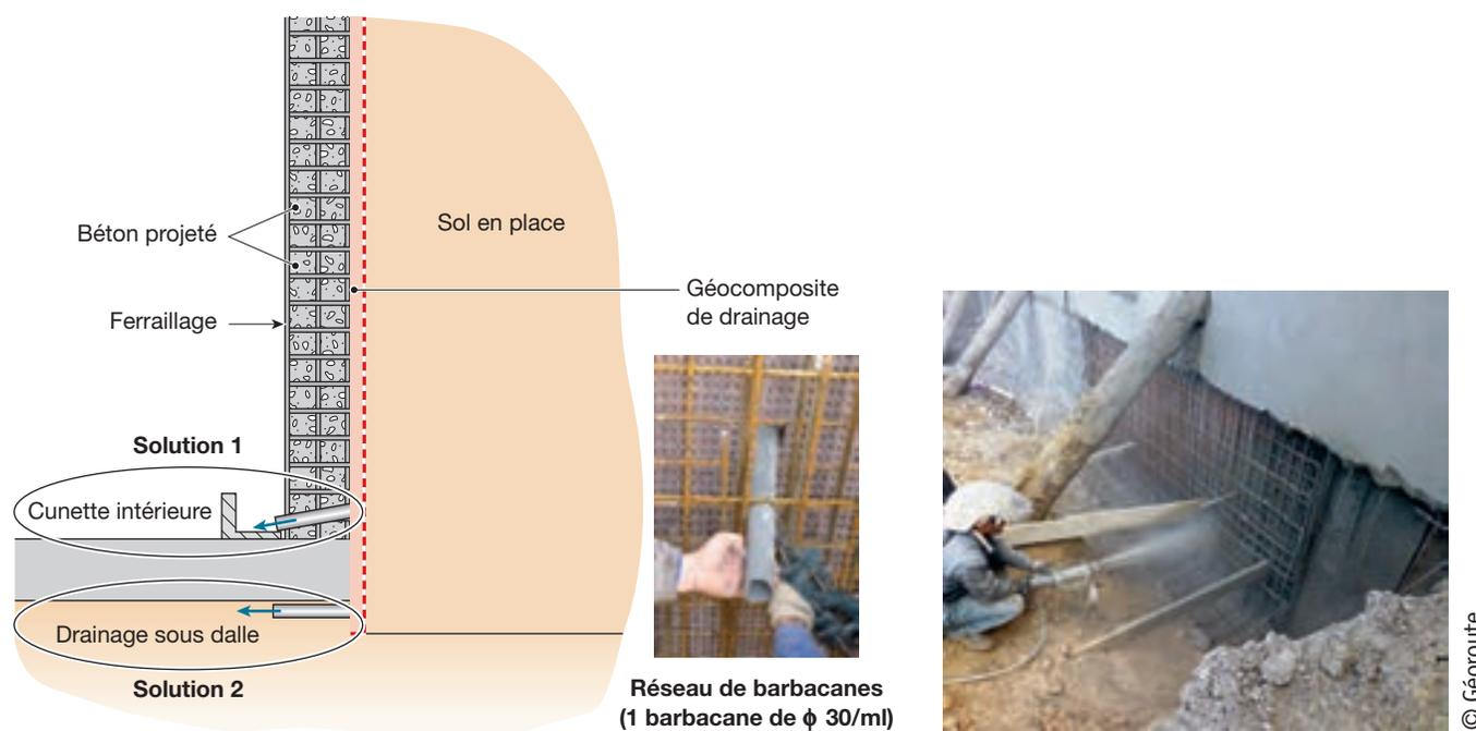
Figure 46. Drainage derrière des voiles par passes avec béton projeté.
