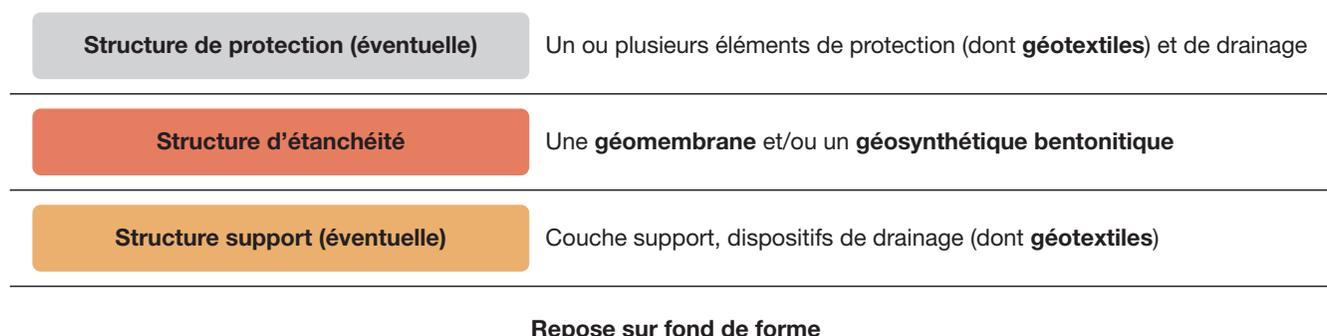
Figure 8. Dispositif d'étanchéité par géosynthétiques (DEG).
