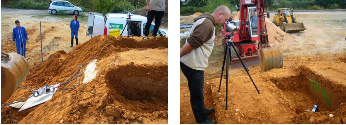
a) dispositif de traction b) enregistrement vidéo de l'extraction Figure 3. Instrumentation de l'expérimentation en vraie grandeur
