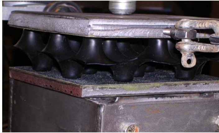
Figure 1. Illustration du léger fléchissement commençant à se produire après 4 jours (96 heures) d'essai sur l'éprouvette 1.
