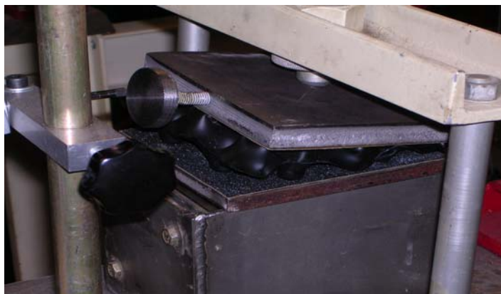
Figure 3. Fléchissement des picots de l'éprouvette 2 après 4 jours (96 heures) d'essai.
