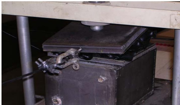
Figure 2. Fléchissement des picots après 5 jours (120 heures) d'essai sur l'éprouvette 1
