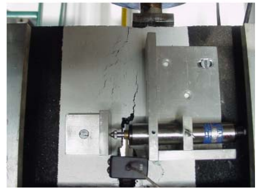
Échantillon renforcé soumis au cisaillement après 570 000 cycles
