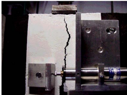
Échantillon non renforcé soumis à un moment fléchissant après 80 000 cycles
