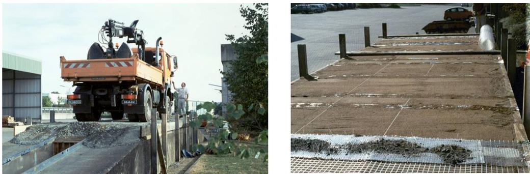
Figure 5 Dalle d'essai et installation du géosynthétique avant chargement
