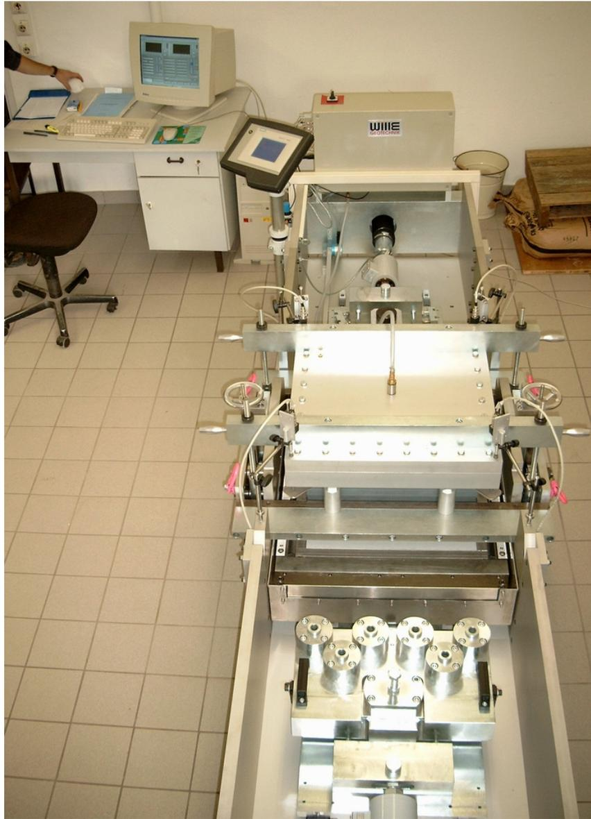
Figure 2. Photographie de l'appareil d'essai d'interaction géosynthétique – sol de l'institut de géotechnique de l'École des Mines et de Technologie de Freiberg.
