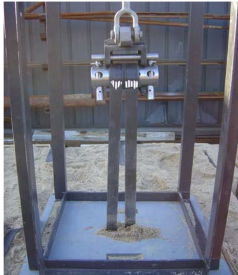
Figure 4. Essais de résistance de la connexion simulant la poussée des terres à l'arrière des écailles.
