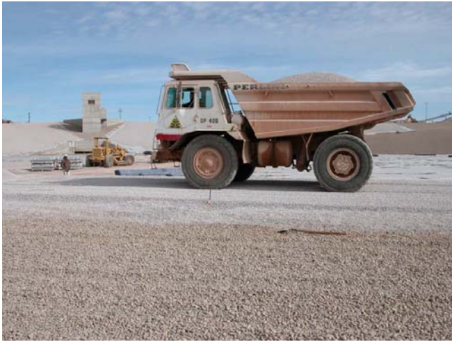
Figure 11. Planche d'essai lors d'une modification de granulométrie sur le fond (janvier et mars 2004). 80 passages avant examen
