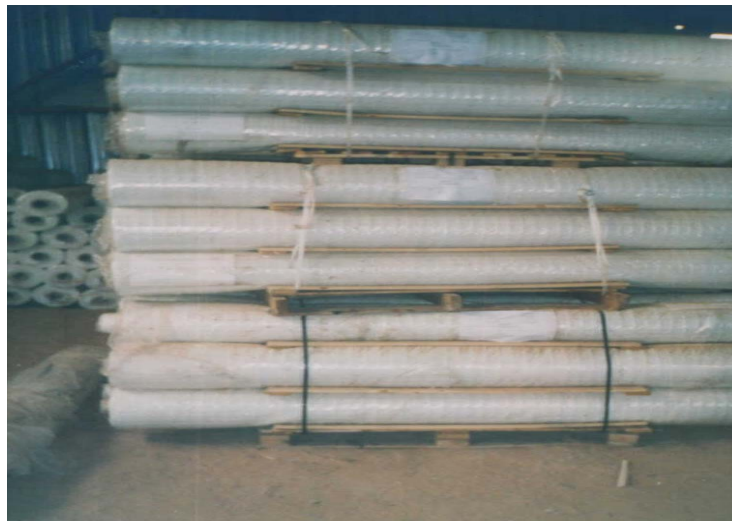
Figure 11. Défaut de stockage (pré-déformation des rouleaux se trouvant en bas du chargement)
