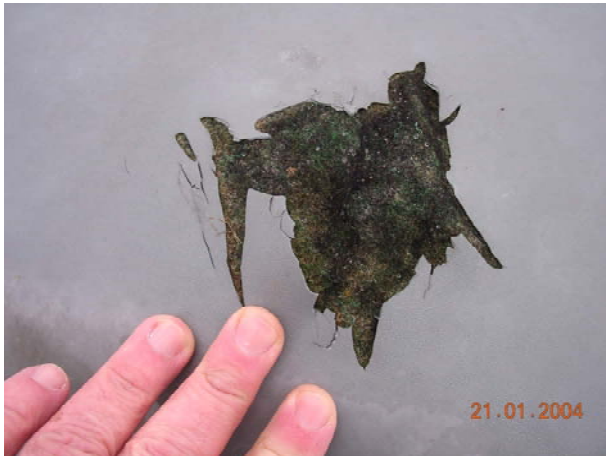
Figure 2. Vue de détail d'une déchirure (rupture fragile)
