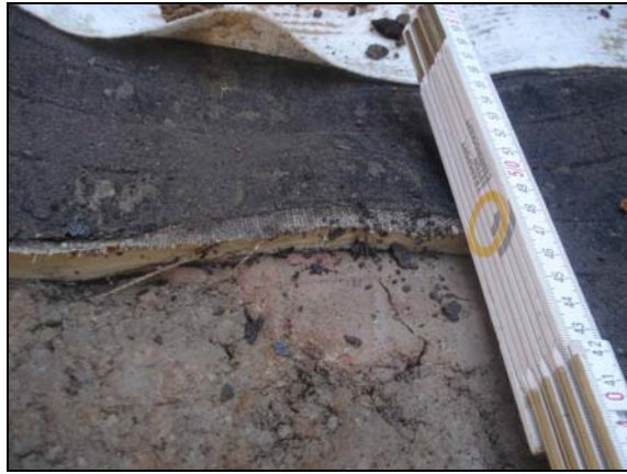
Figure 6. Vue de la tranche du GSB après prélèvement et du sol support sur l'ISD B
