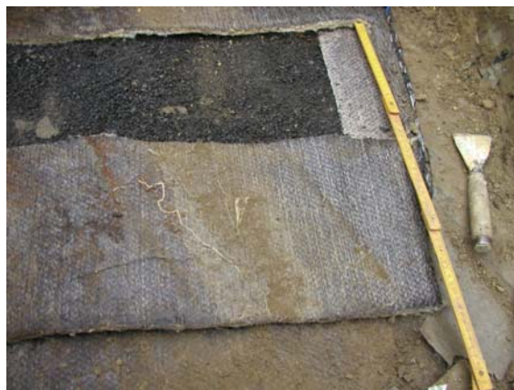
Figure 8. Vue du GSB C avec des racines et du sol support
