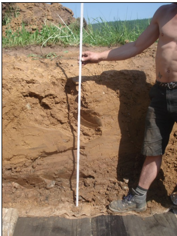
Figure 5. Sol de couverture sur l'ISD B
