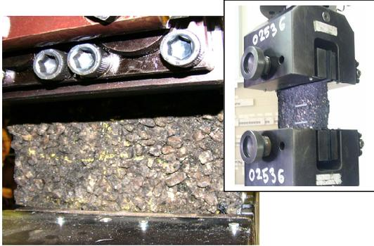
Figure 6. Essai de traction sur ESRG
