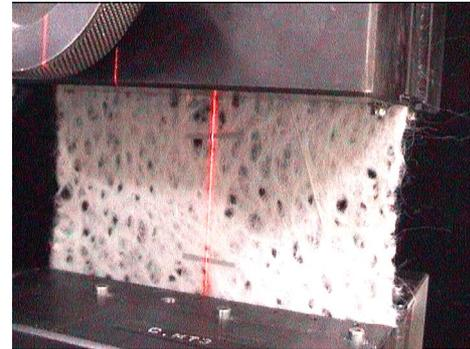
Figure 7. Essai de traction sur géotextile après lavage au perchloréthylène
