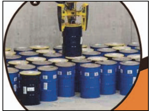
Figure 12. Système automatisé de stockage au CSFMA (Andra 2010).
