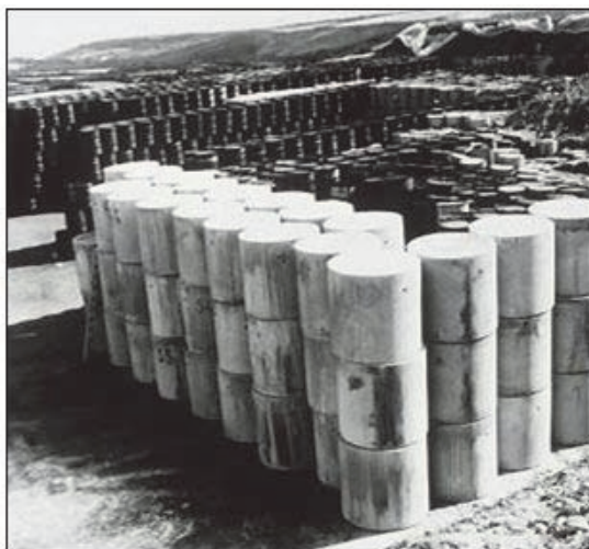
Figure 7. Stockage sur dalle en béton (CSM).
