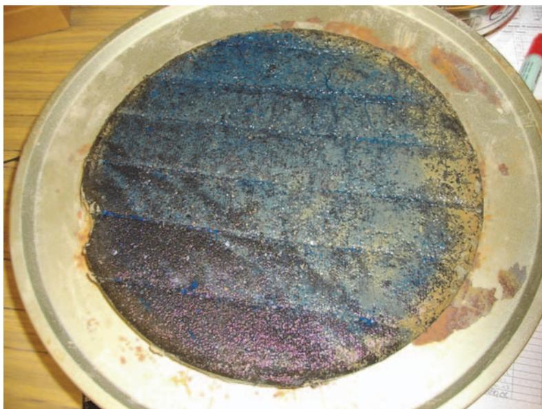
Figure 4. Eprouvette de GSB après percolation avec le colorant bleu
