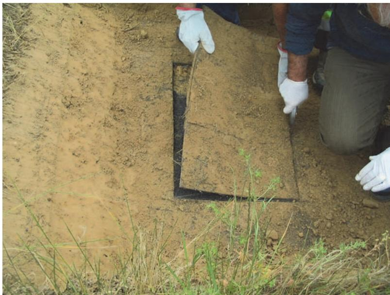
Figure 2. Échantillon de GSB découpé et transféré sur un support rigide.
