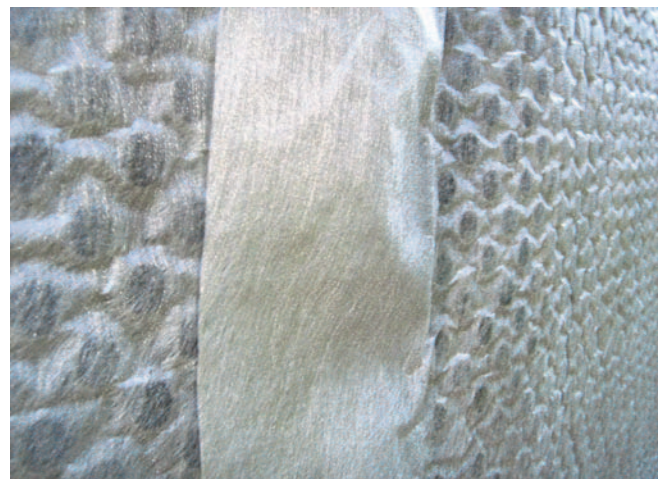
Figure 7. Géospaceur avec couche filtrante
