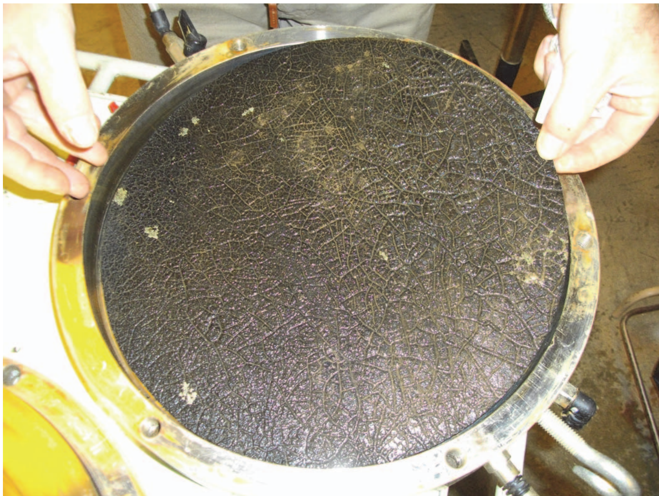
Figure 2. Aspect de l'état de surface de l'éprouvette 1 avant essai de mesure de flux
