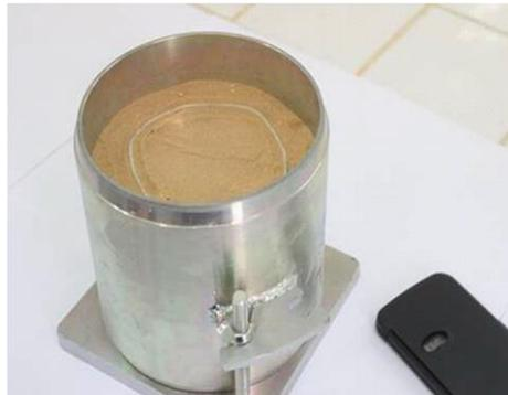
Figure 3. SDD incluant une cellule cylindrique en géotextile.
