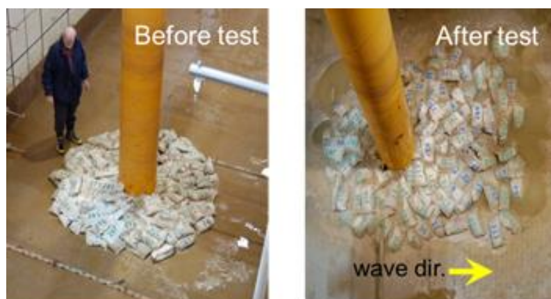
Figure 13. Des essais à grande échelle de la protection de l'affouillement des fondations des éoliennes offshore (Gruene et al, 2007).
