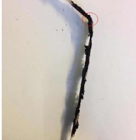
Figure 3. Fil chaîne 100kN/m poinçonné
