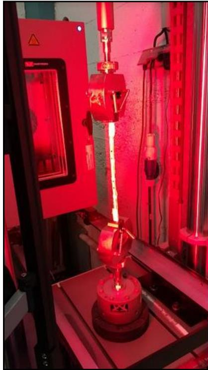
Figure 5. Dispositif d'essais de fatigue en traction sur fils. Les mesures des déformations sont réalisées par un extensomètre sans contact
