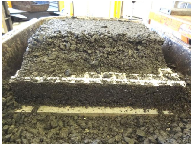
Figure 8. Phase de récupération de la grille après compactage pour l'essai CD
