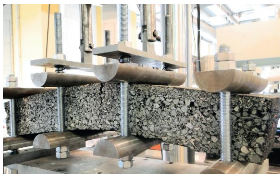
Figure 9. Vue du montage pour l'essai F4PU
