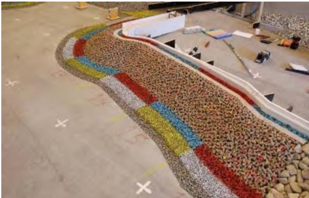
Figure 6. Modèle physique 3D en cuve à houle en cours de construction
