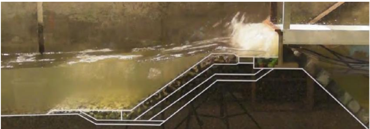
Figure 5. Essai en canal à houle – impact de la houle sur le mur chasse mer
