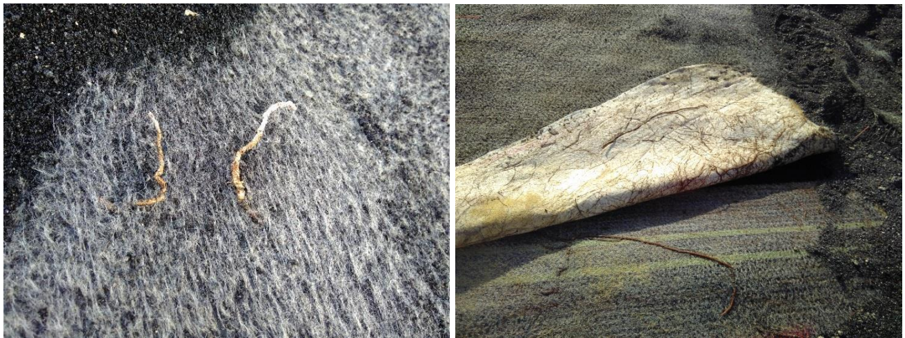
Figure 4. Racine perforant le GSB (gauche) et développement d'un réseau racinaire sur le GSB (droite)
