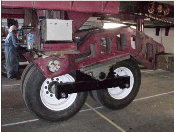
Figure 5. Engrenage à double roue à essieu tandem utilisé dans les tests ERDC
